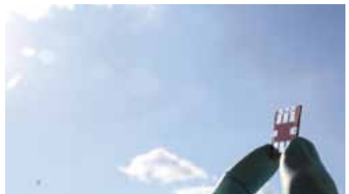
Fotografía temática: un dispositivo que contiene seis células solares orgánicas fabricado en el Instituto de Ciencia de Materiales de Barcelona (ICMAB-CSIC).
